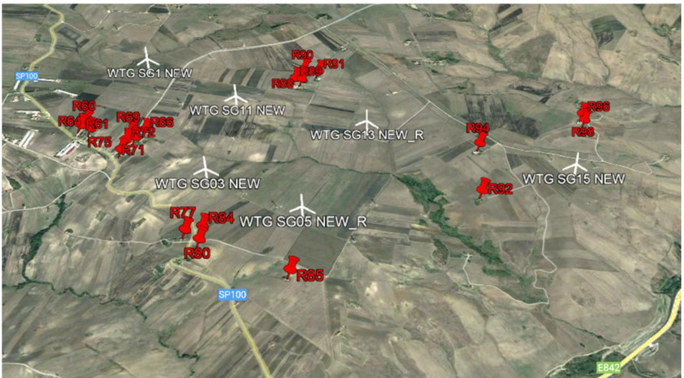
Figura 8: Vista aerea delle nuove turbine impianto in sostituzione in località Piano d'Olivola Pezza del Tesoro con ubicazione dei ricettori residenziali (rossi)
