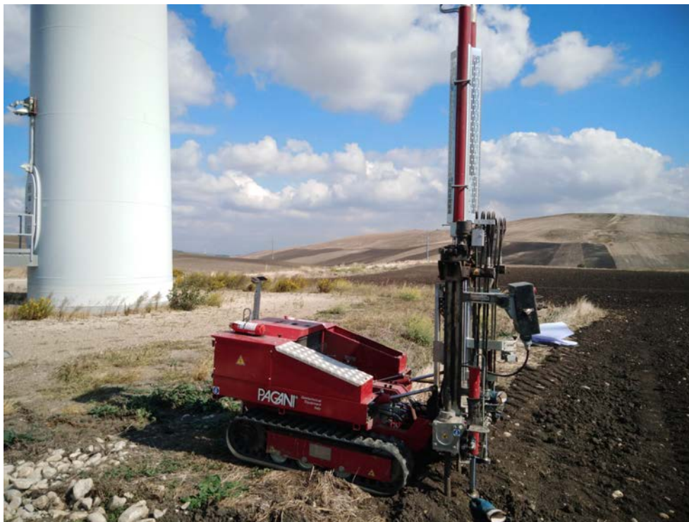
Prova penetrometrica statica CPT 03
