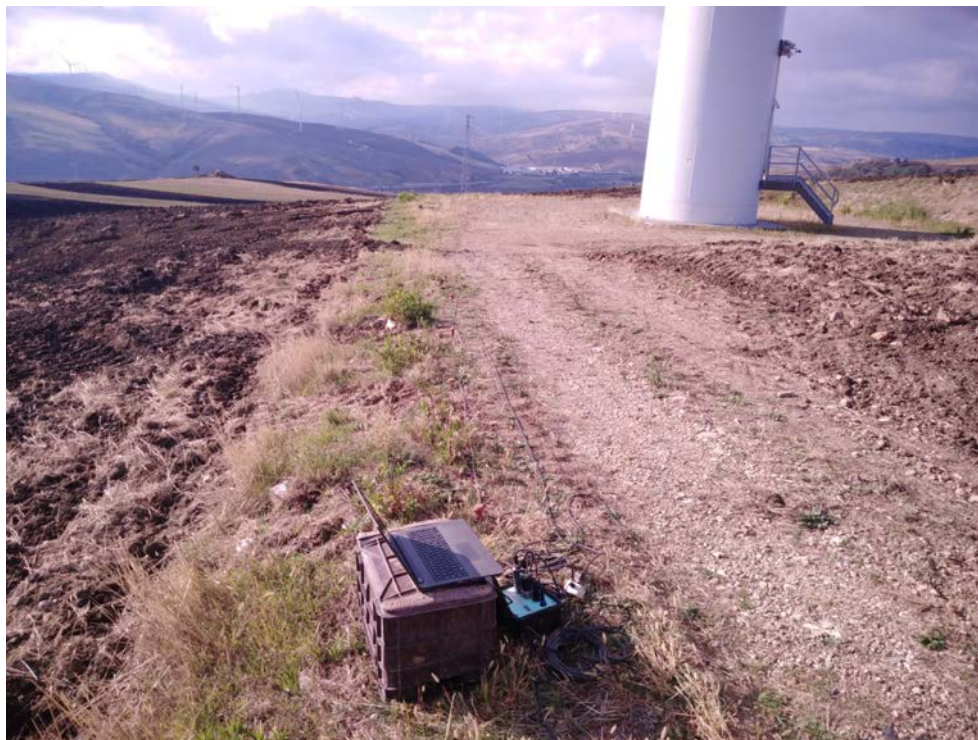
Indagine sismica di superficie Masw M1
