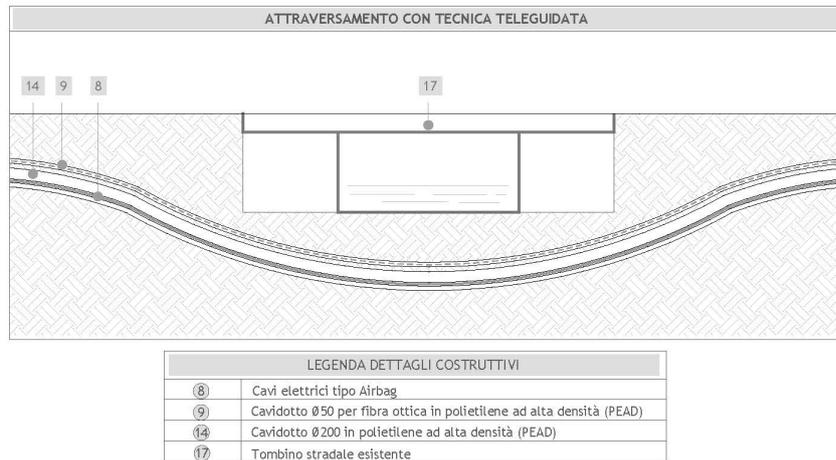
Figura 9 – Particolari costruttivi del Cavidotto MT\_TOC
