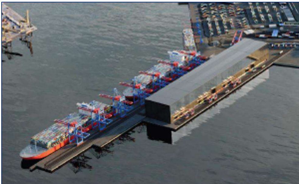
Figura 3-11. Ricostruzione della vista a volo d'uccello della soluzione Box Bay.
