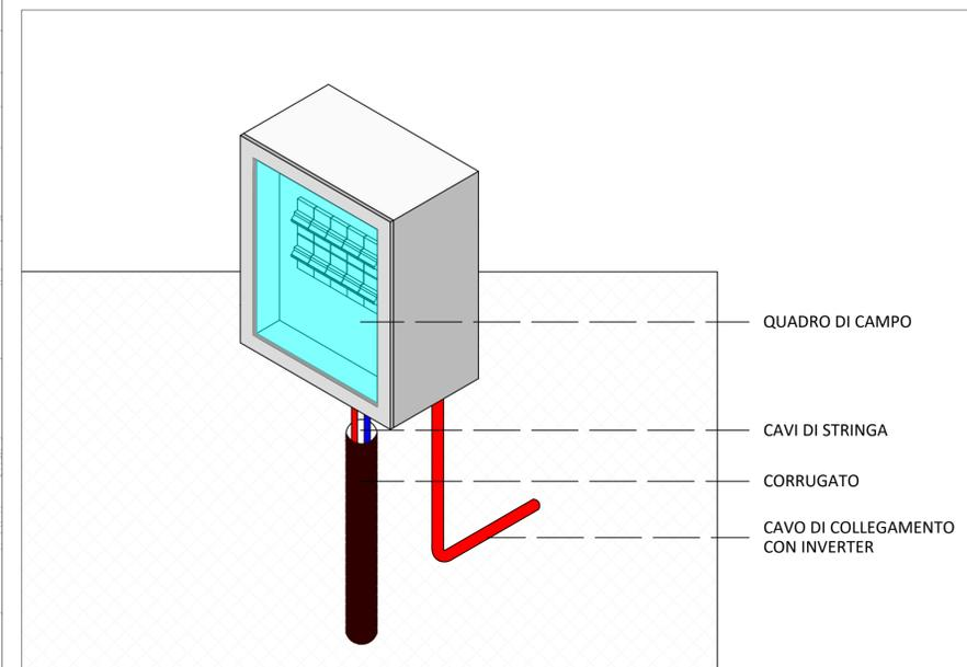
PARTICOLARE TIPO : Collegamento moduli-quadri di campo 1:20
