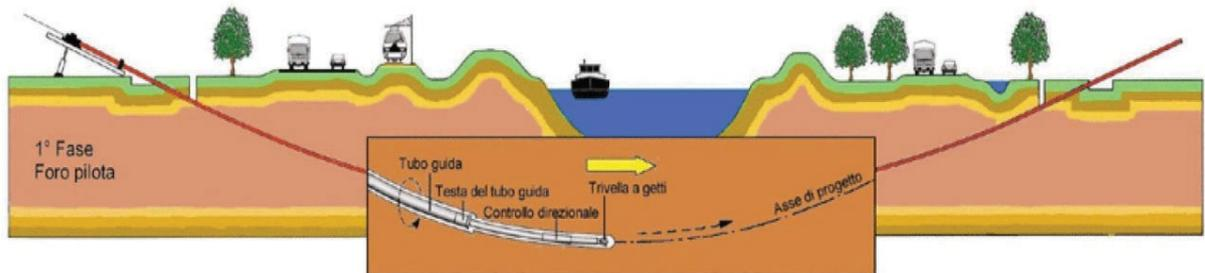
**FIG 13 Schema della fase di realizzazione del foro pilota.**
