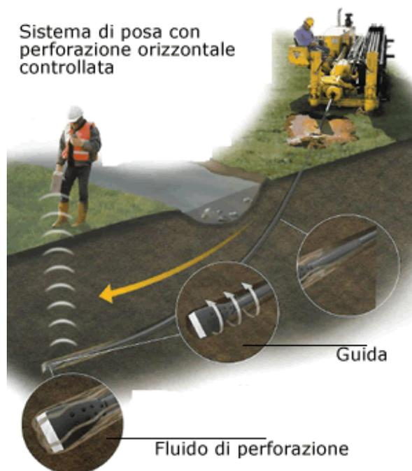
**FIG 12 Sistema di trivellazione orizzontale controllata (T.O.C.).**
