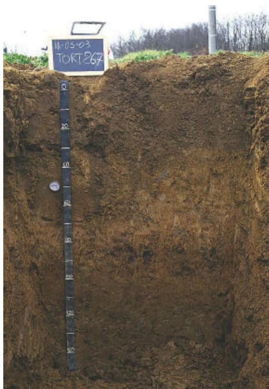
0-30 cm: orizzonte compreso tra la superficie e la profondità delle arature (corrisponde al **topsoil**). Il colore scuro identifica una presenza di sostanza organica maggiore rispetto alla parte sottostante.
