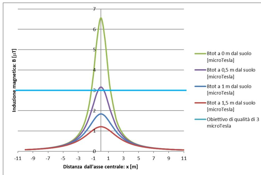
Andamento del campo magnetico generato dal cavidotto, composto da tre terne due da  $630 \text{ mm}^2$  e una da  $120 \text{ mm}^2$
