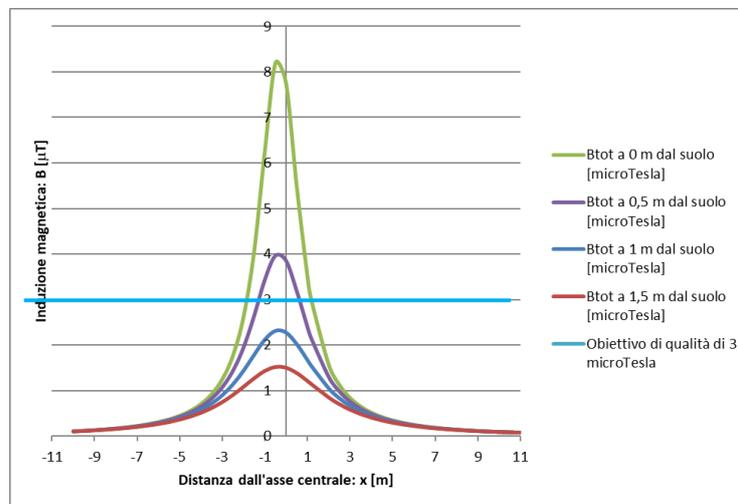
Figura 3: Andamento del campo magnetico generato dal cavidotto, composto da due terne da 630 mm<sup>2</sup>
