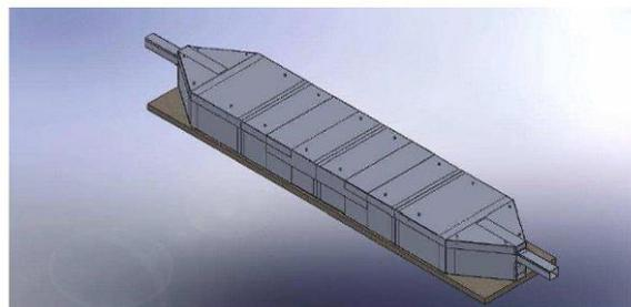
Azienda leader nel settore delle schermature di campi magnetici a frequenza industriale, nonché produttrice di canalette schermanti omologate da Terna nel 2009, ha eseguito, mediante il software dedicato FC400, studi teorici sulla capacità schermante delle canalette nei confronti del campo magnetico emesso dai cavi aventi medesime caratteristiche, elettriche e di posa, dei cavi utilizzati per la realizzazione dell'elettrodotto in cavo oggetto della seguente relazione.
