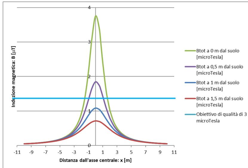
Andamento del campo magnetico generato dal cavidotto, composto da due terne una da 120 mm<sup>2</sup> e una da 400 mm<sup>2</sup>
