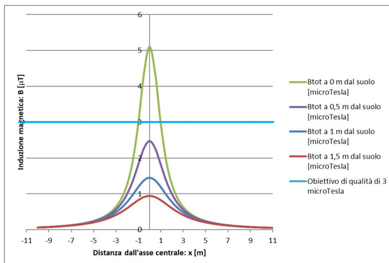
Andamento del campo magnetico generato dal cavidotto, composto da due terne una da 630 mm<sup>2</sup> e una da 400 mm<sup>2</sup>
