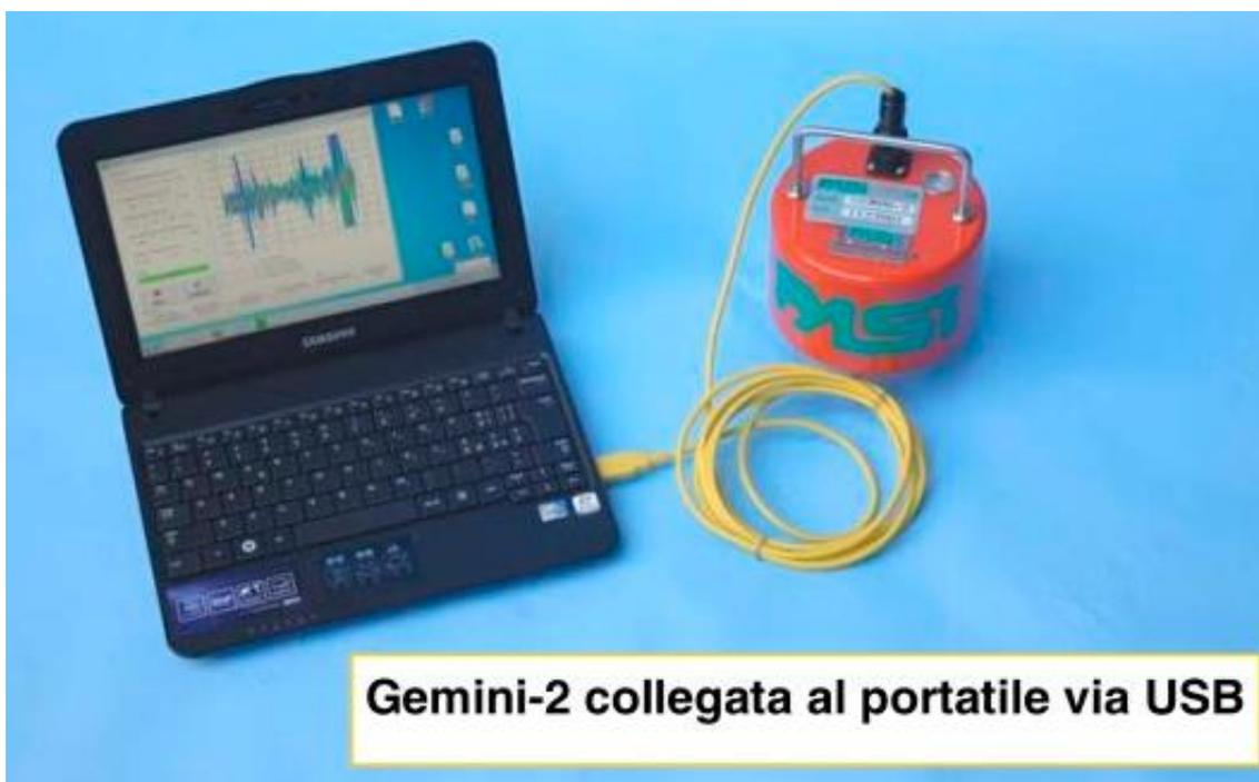
Fig. 4 Sismografo Pasi Gemini 2.
