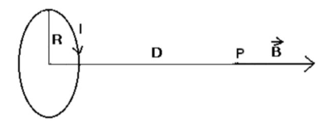
A frequenza industriale (50 Hz) ai fini del calcolo del campo magnetico generato dalla spira, si può ricorrere alla legge di Biot e Savart, la quale porta alla seguente formula analitica per l'induzione magnetica B (T) nel punto P alla distanza D (m) dal centro della spira lungo l'asse passante per tale centro e ortogonale al piano della spira:
