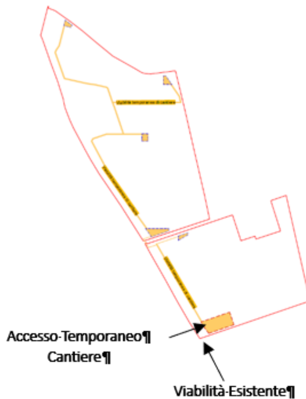
Figura 5-6. Accessi temporanei alle aree di cantiere e viabilità esistente
