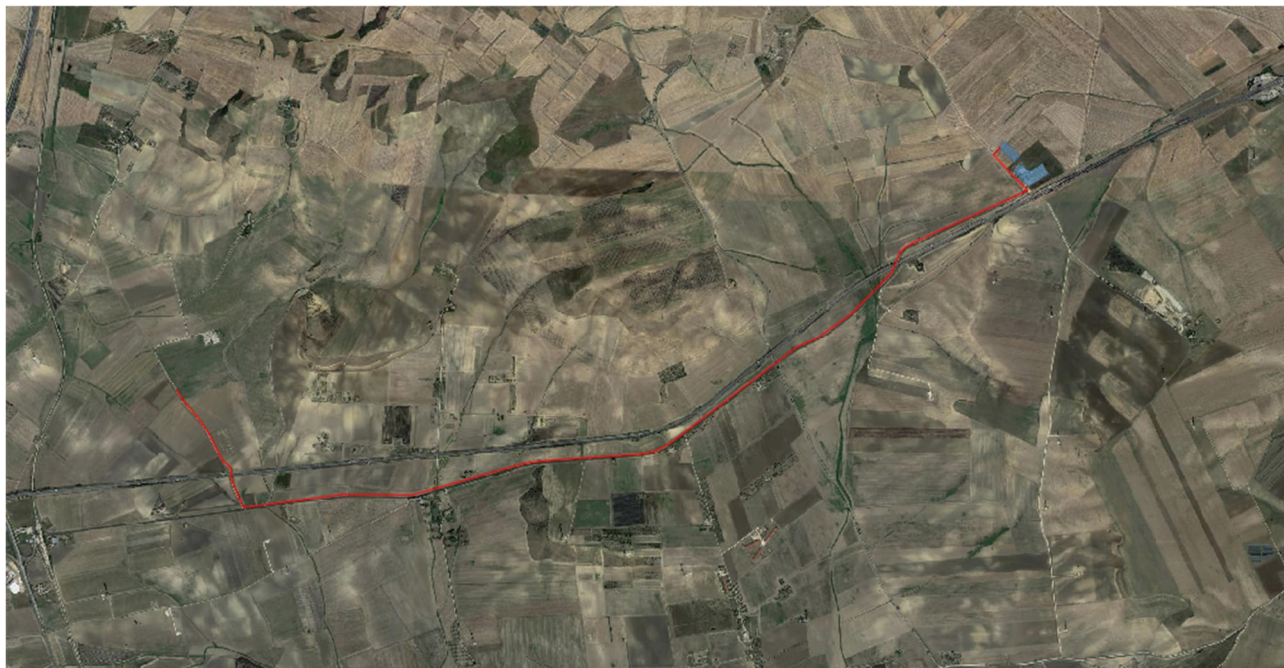
Figura 3-1: Localizzazione area di intervento, in blu la perimetrazione dell'area SSE e SE, rosso il tracciato dell'elettrodotto interrato
