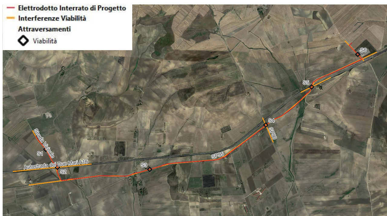
Figura 4-2: Inquadramento elettrodotto e individuazione delle viabilità
