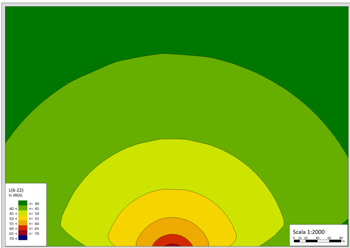
Figura 4-6 Mappatura acustica in sezione verticale: cantiere mobile connesso alla realizzazione del cavidotto.
