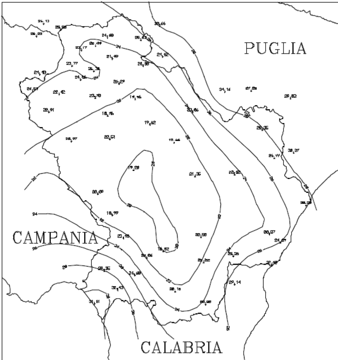
Figura 24 - Iso linee del coefficiente a della curva di probabilità pluviometrica.
