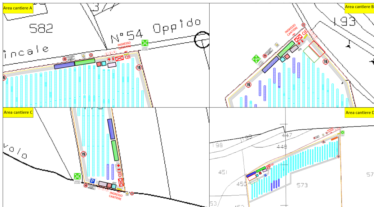
Figura 44 - Stralcio sistemazione aree di cantiere
