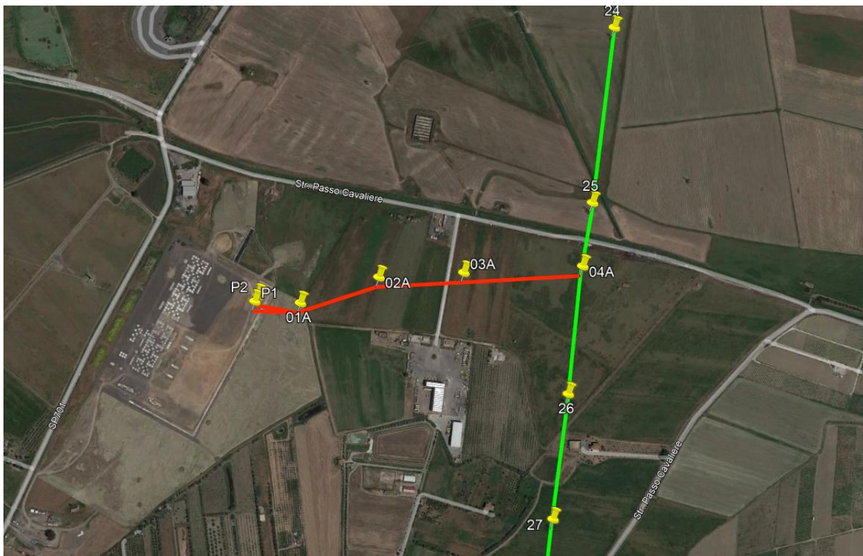
Figura 2. Ortofoto derivazione provvisoria 220 kV di una terna dalla linea in doppia terna 220 kV "Misterbianco – Melilli"
