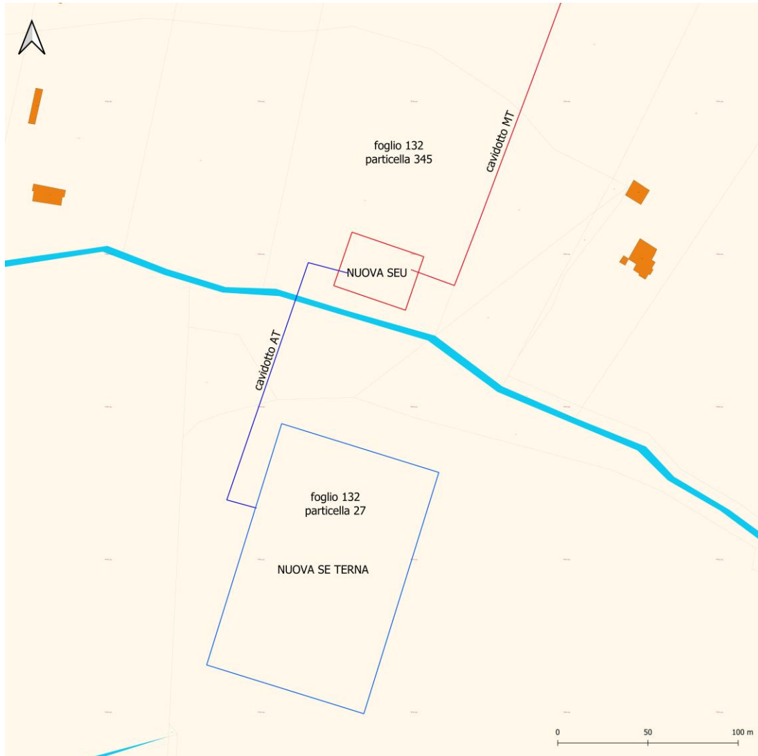
Figura 28: Inquadramento su stralcio di mappa catastale delle nuove SE e SE (scala 1:1000)
