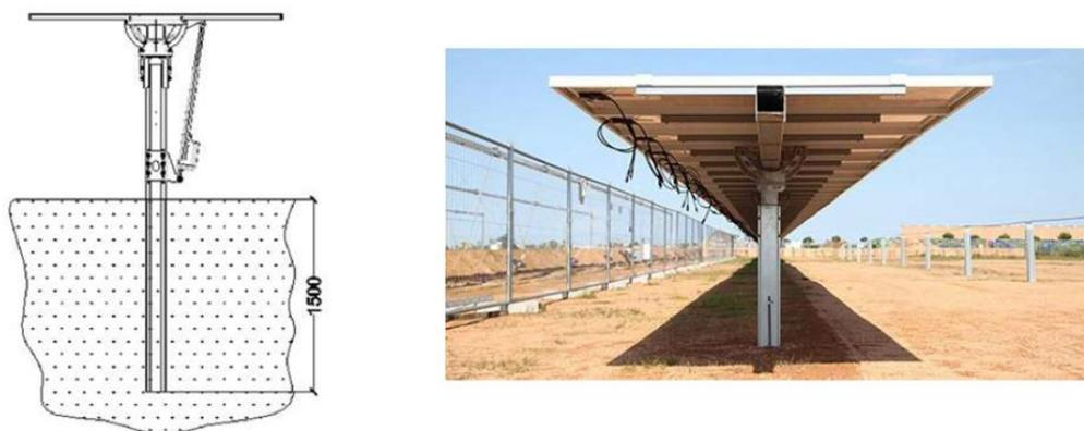
Figura 3: Sezione della profondità di infissione dei pali di sostegno e particolare dei moduli pronti al cablaggio
