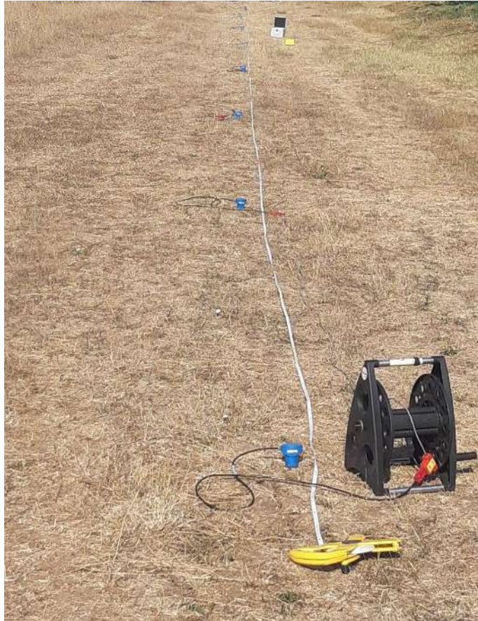
Fig. 32 - Foto della preparazione della prospezione sismica Masw
