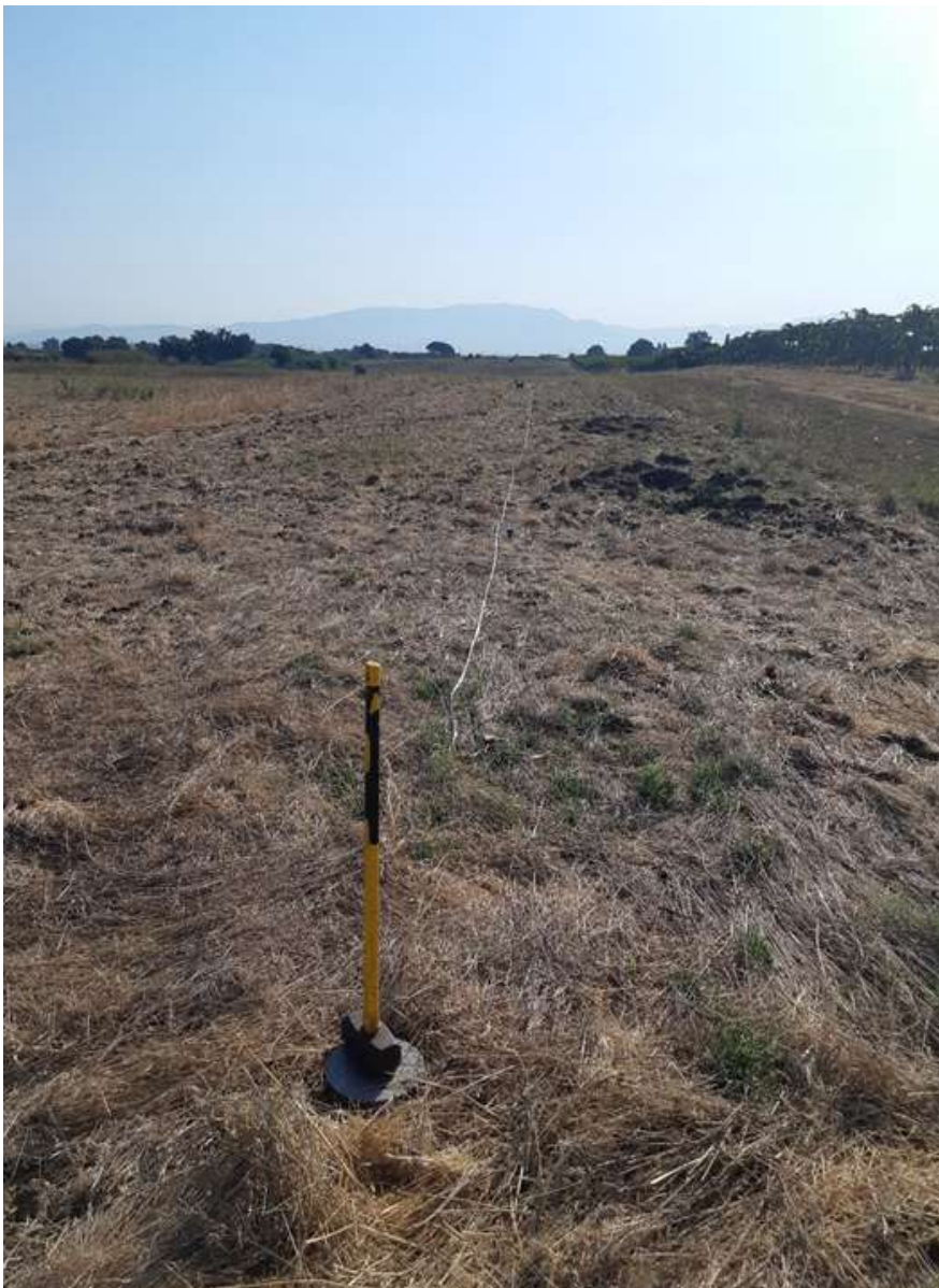
Fig. 16 - Foto della preparazione propezione sismica Masw
