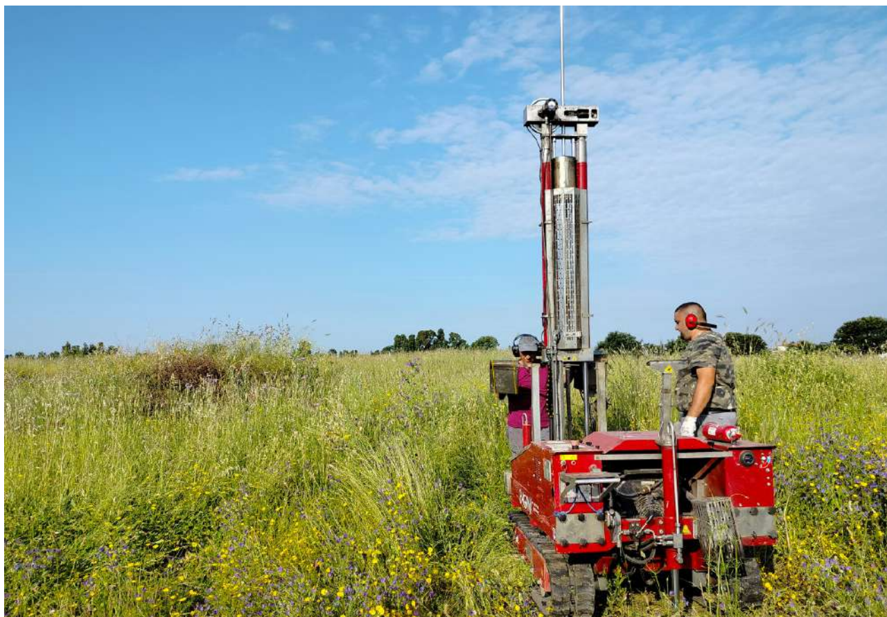
Foto 1 - Esecuzione DPSH n.1
