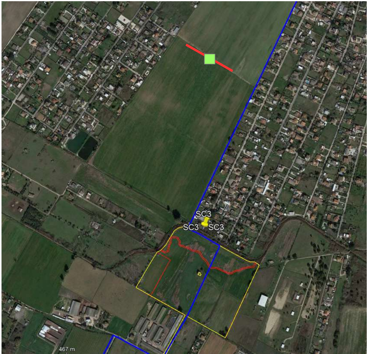
Fig. 27 – Ubicazione delle indagini geofisiche su ortofoto SOTTOCAMPO 4 Scala 1:1.000 Masw in rosso – HVSR in verde
