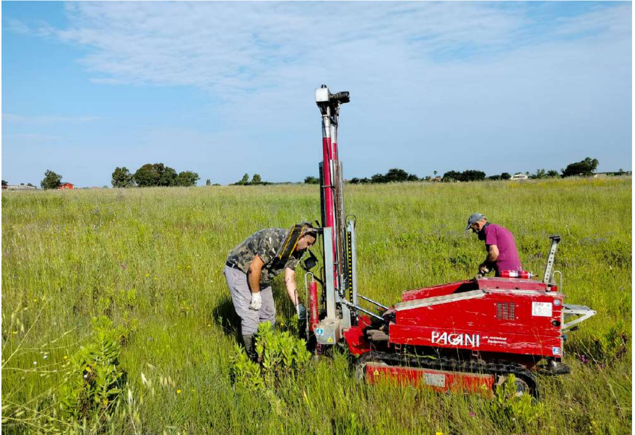
Foto 3- Esecuzione DPSH n.3
