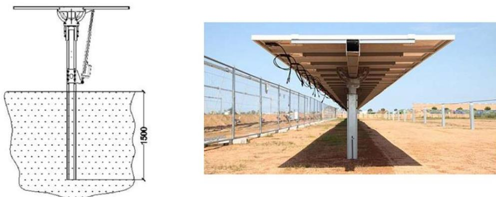
Figura 8: Sezione della profondità di infissione dei pali di sostegno e particolare dei moduli pronti al cablaggio
