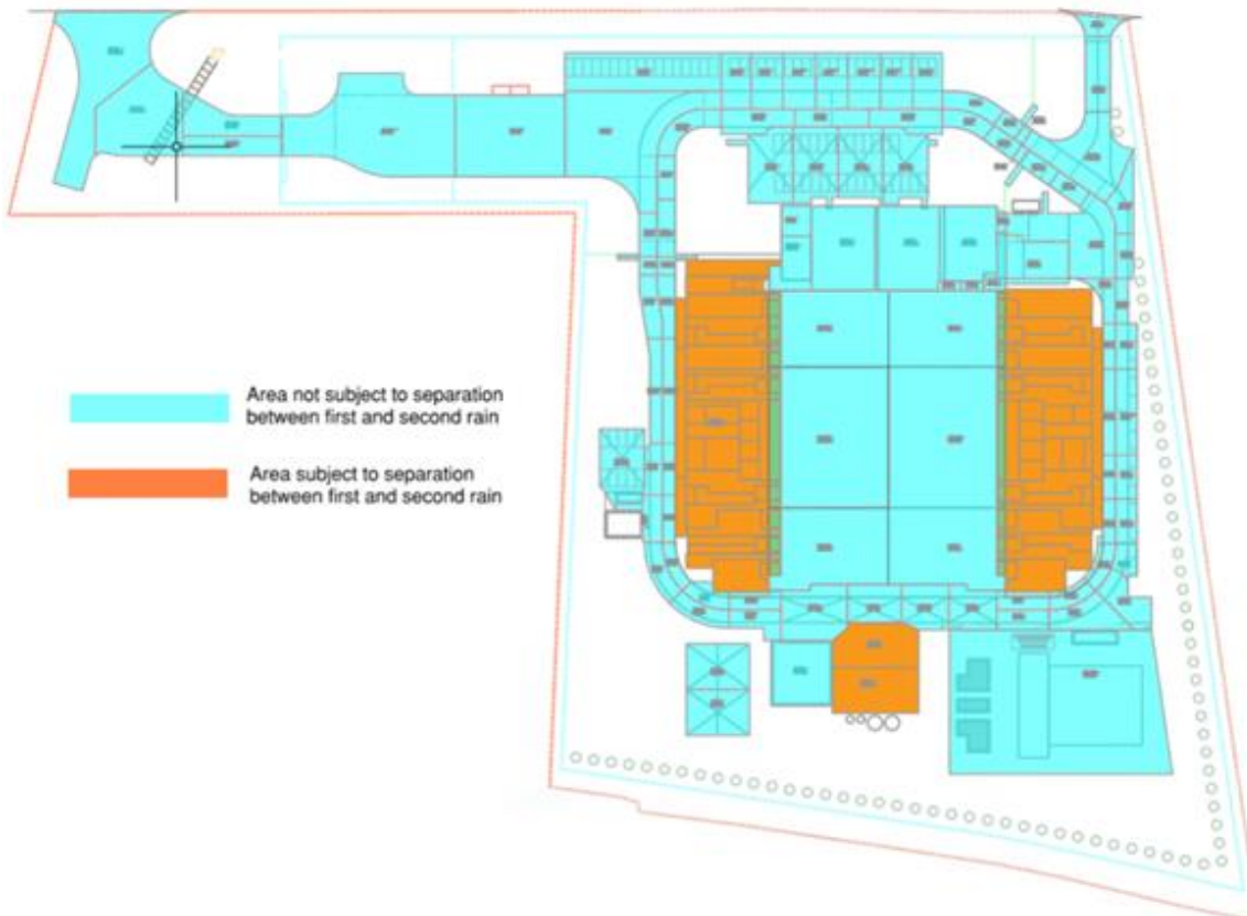
Figura 5-9: Aree del Data Center soggette a separazione
