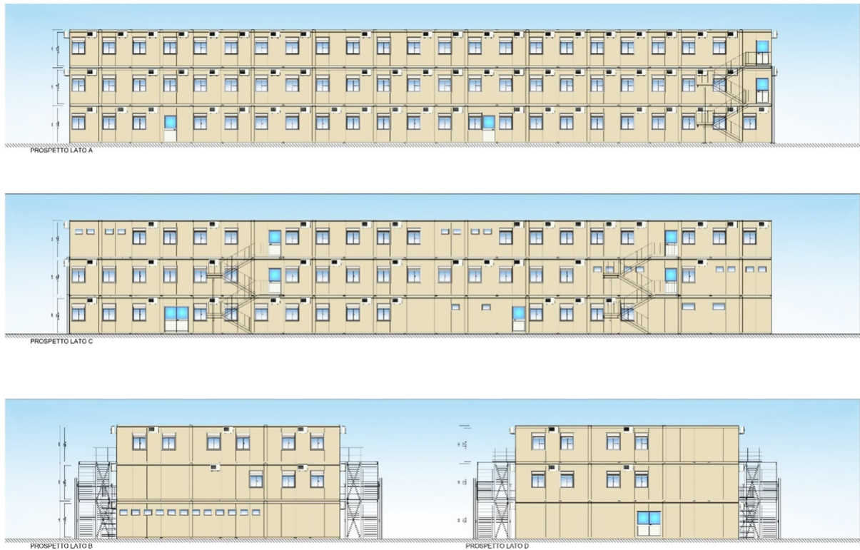
Figura 4-2: Esempio di baracche di cantiere su 3 piani.
