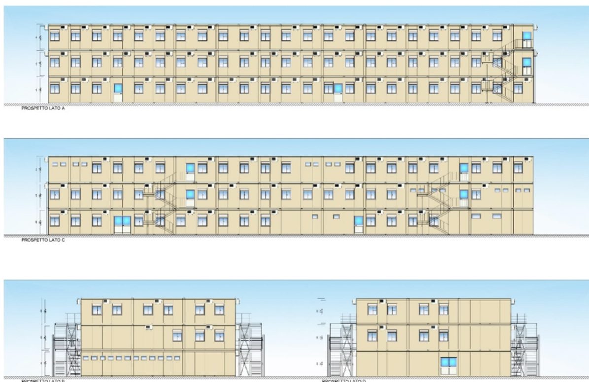
Figura 8-5: Esempio di baracche di cantiere su 3 piani.
