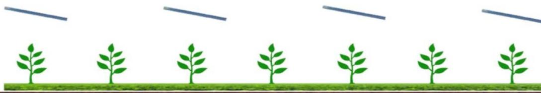
Figura 31 - Sistema agrivoltaico in cui la coltivazione avviene tra le file dei moduli fotovoltaici, e sotto a essi (TIPO 1)
