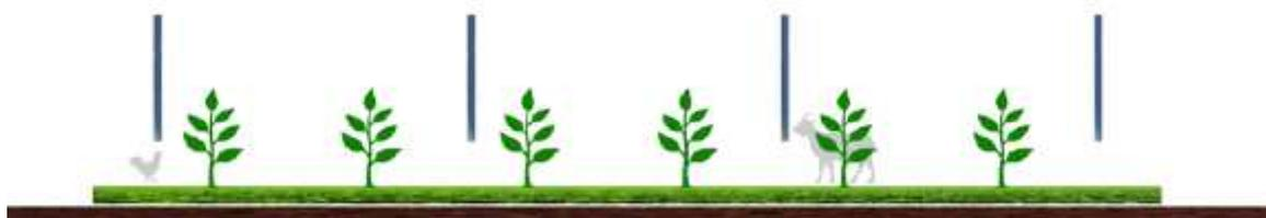
Figura 33 - Sistema agrivoltaico in cui i moduli fotovoltaici sono disposti verticalmente. La coltivazione avviene tra le file dei moduli fotovoltaici, l'altezza minima dei moduli da terra influenza il possibile passaggio di animali (TIPO 3)
