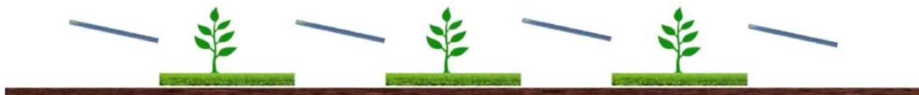
Figura 32 - Sistema agrivoltaico in cui la coltivazione avviene tra le file dei moduli fotovoltaici, e non al di sotto di essi (TIPO 2)
