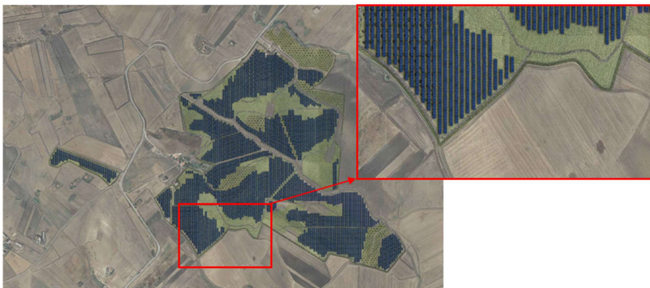
Figura 19 - Dettaglio - Fascia di mitigazione perimetrale
