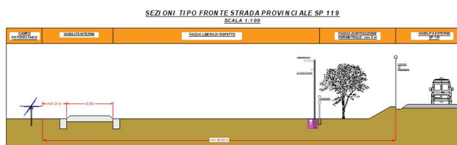
Figura 9 – Sezione tipologica recinzione a confine con S.P. 119
