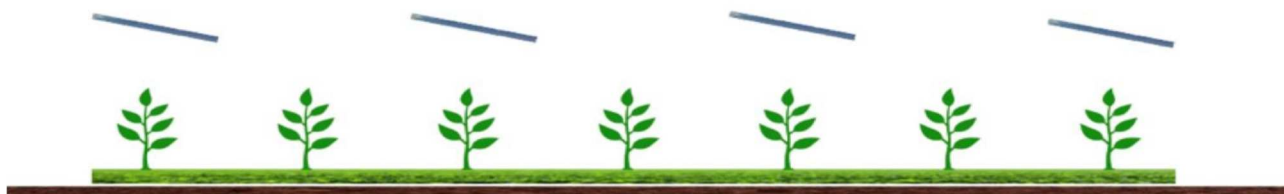
Figura 2 - Sistema agrivoltaico in cui la coltivazione avviene tra le file dei moduli fotovoltaici, e sotto a essi (TIPO 1)
