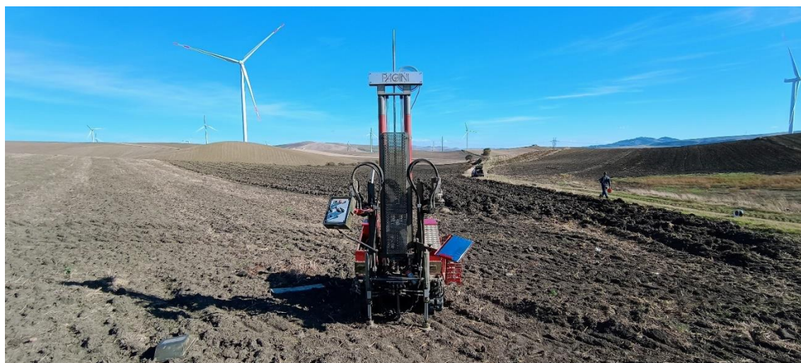
Figura 9 - Esecuzione della Prova penetrometrica DPSH 4
