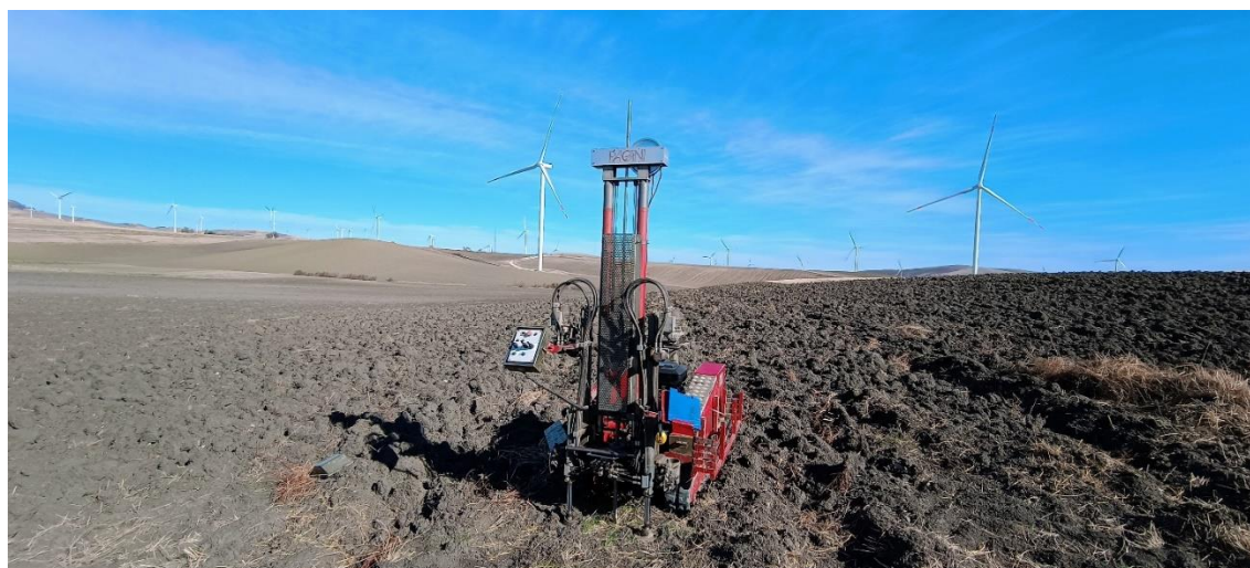
Figura 8 - Esecuzione della Prova penetrometrica DPSH 3
