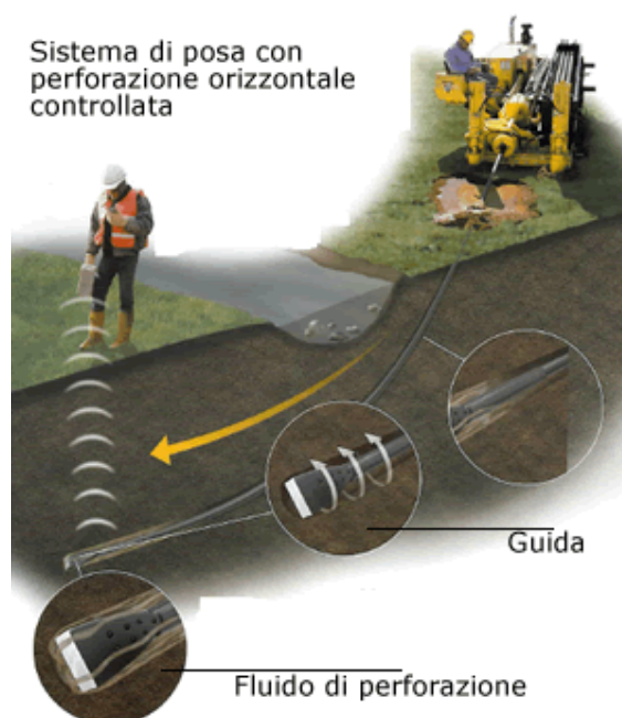
Figura 43: Sistema di trivellazione orizzontale controllata (T.O.C.).
