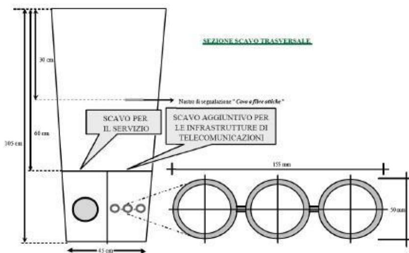
Figura 5 - Sezione tipo per posa tritubo
