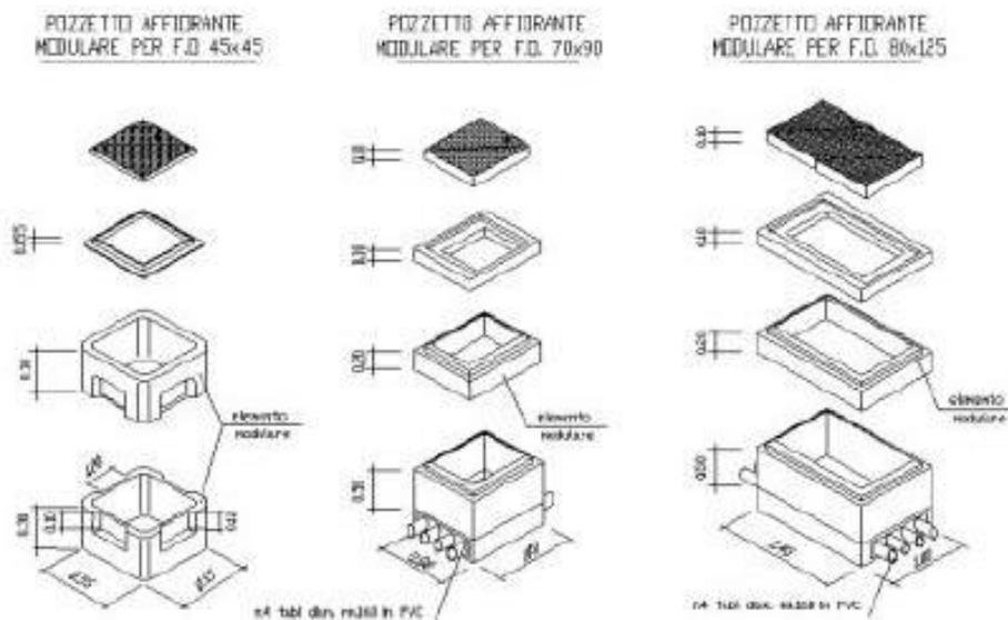
Figura 6 - Tipologia pozzetti
