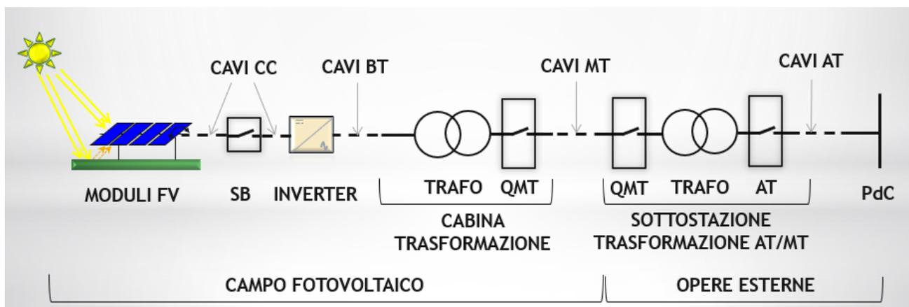
L'impianto FV ha la capacità di generare energia elettrica dai Moduli FV: ogni singolo Modulo FV trasforma l'irraggiamento solare in energia elettrica, generata in forma di corrente continua.
