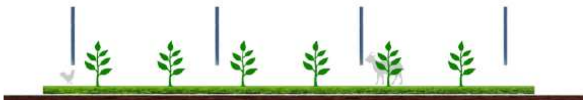
Figura 4 - Sistema agrivoltaico in cui i moduli fotovoltaici sono disposti verticalmente. La coltivazione avviene tra le file dei moduli fotovoltaici, l'altezza minima dei moduli da terra influenza il possibile passaggio di animali (TIPO 3)
