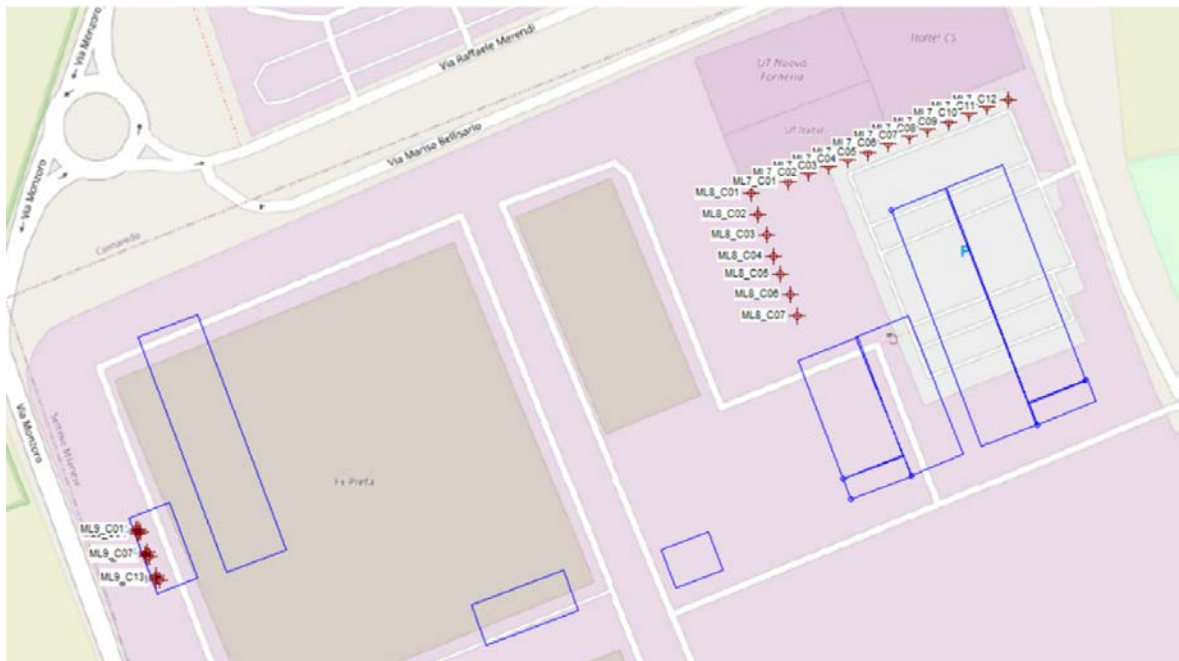
Figura 5-3: Localizzazione punti di emissione (a sinistra i 16 generatori ML9, a destra i 12 generatori ML7 e i 7 generatori ML8)
