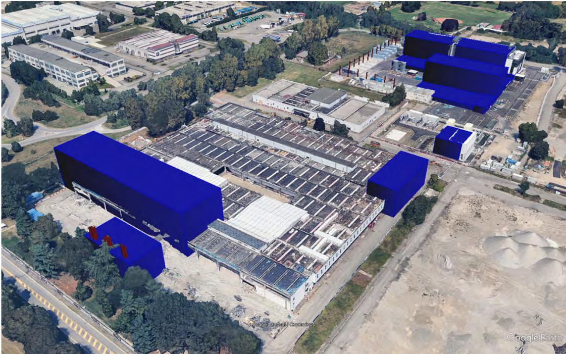
Figura 5-10 | Ricostruzione tridimensionale dell'area di impianto con ubicazione delle sorgenti simulate (in rosso) e degli edifici considerati per l'effetto building downwash (in blu).
