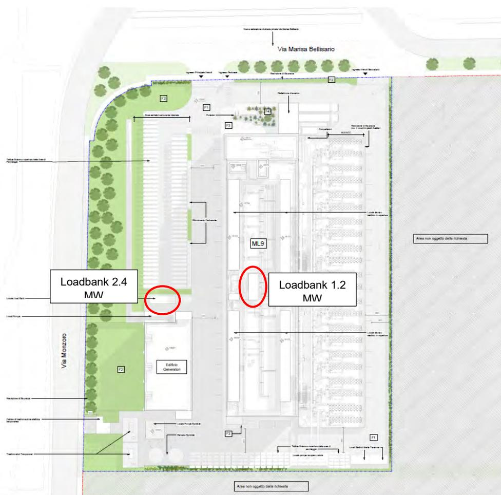
Secondo le misure fonometriche fornite dalla committenza, ed effettuate dal produttore dei loadbank durante il funzionamento al 100% di carico, risulta un livello di pressione sonora media pari a 75 dB(A) ad un metro di distanza dall'involucro dello stesso:
