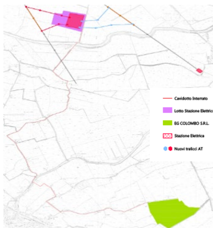
Figura 4 – Linea elettrica MT (rosso) di collegamento impianto (verde) alla stazione SE RTN
