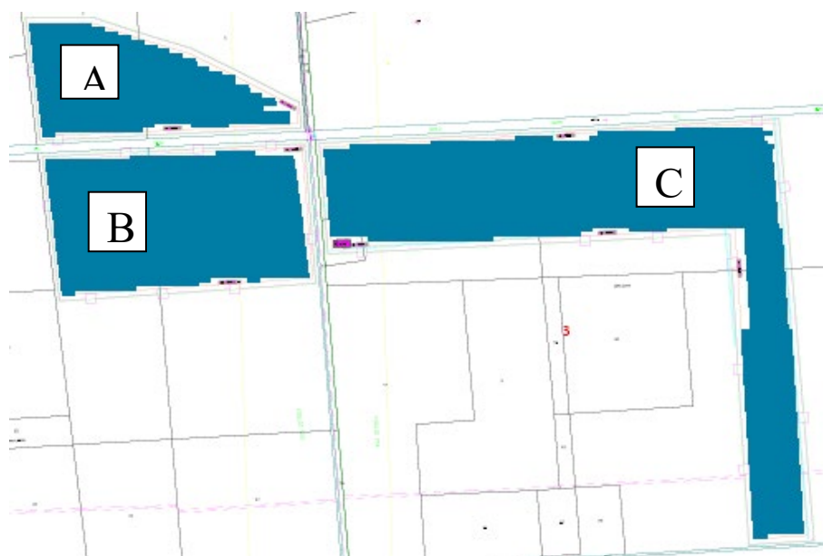
Figura 5 Configurazioni moduli negli 8 sottocampi, superficie occupata dai pannelli (166.000 m 2 )
