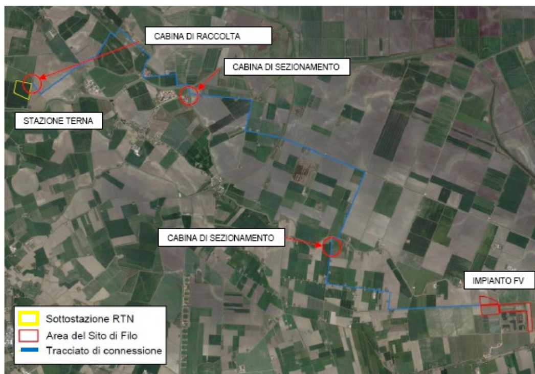
Figura 8 – Inquadramento Cabine di Raccolta e di Sezionamento
