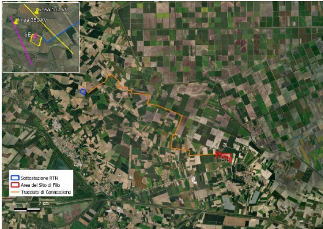
Figura 6 – Linea elettrica di collegamento tra campi impianto e RTN; dettaglio connessioni 380 e 132 kV
