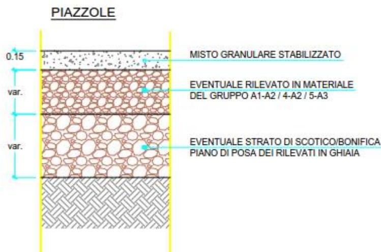
Figura 5.4: sezione tipo delle piazzole
