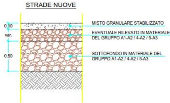
Figura 5.2: tipico per viabilità di nuova realizzazione
