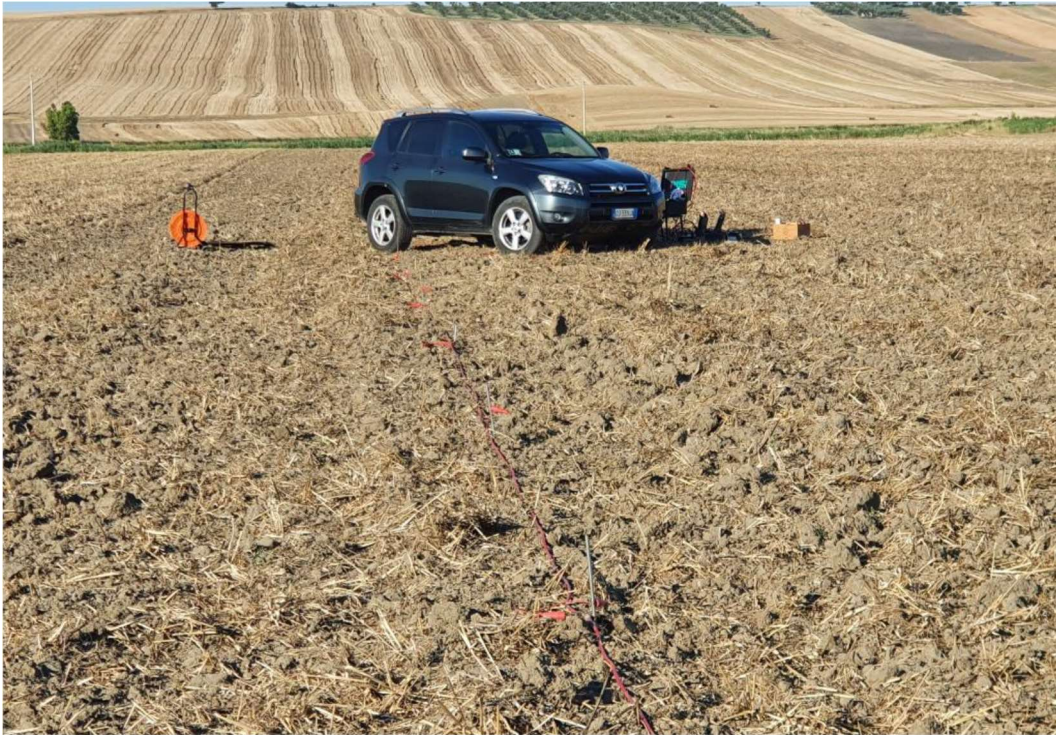
Foto 1 - Particolare esecuzione indagine sismica
