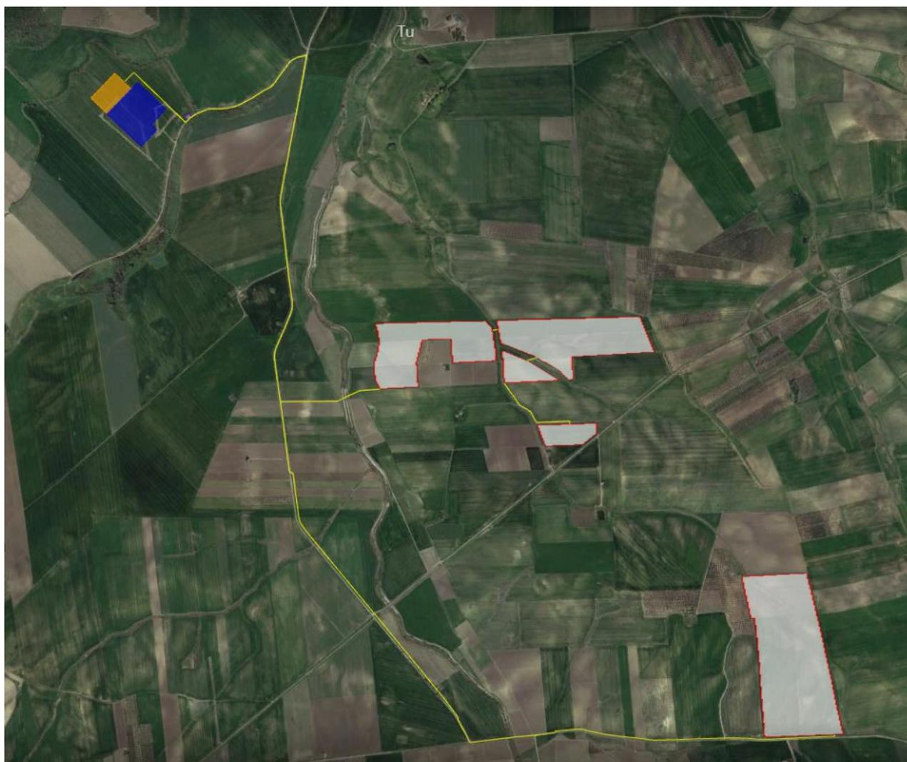
*Figura 4-2 - Soluzione di Connessione alla SE - In giallo il percorso di connessione dal campo FV (aree bianche con contorno rosso) alla nuova SE di Trasformazione (area blu più area arancione)*
