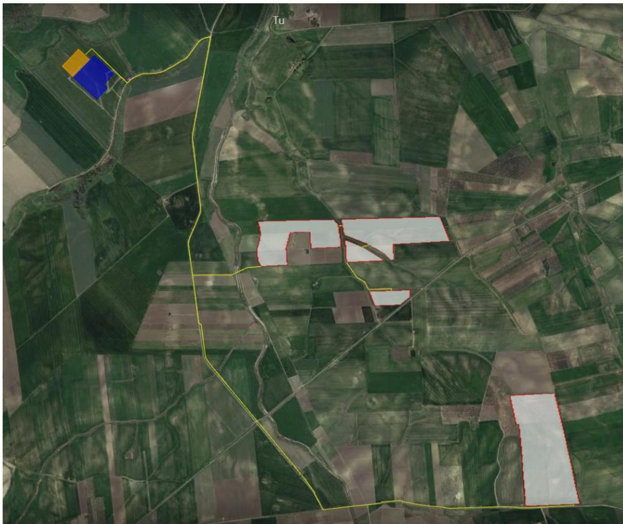
*Figura 5.1 - Soluzione di Connessione alla SE - In giallo il percorso di connessione dal campo FV (aree bianche con contorno rosso) alla nuova SE di Trasformazione (area blu più area arancione)*
