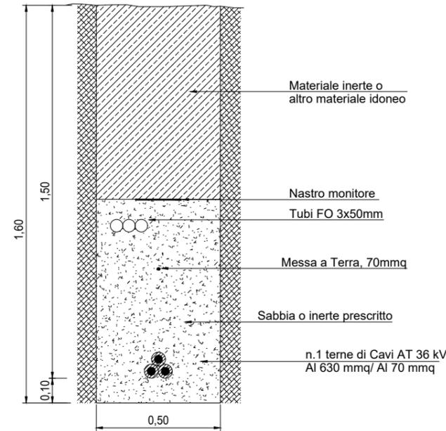
**ESEMPIO DI UTILIZZO DELLA MACCHINA T.O.C. PER LA REALIZZAZIONE DELLA TRIVELLAZIONE TRASVERSALE ( SEZIONE CAVIDOTTO ) (scala 1:200)**
