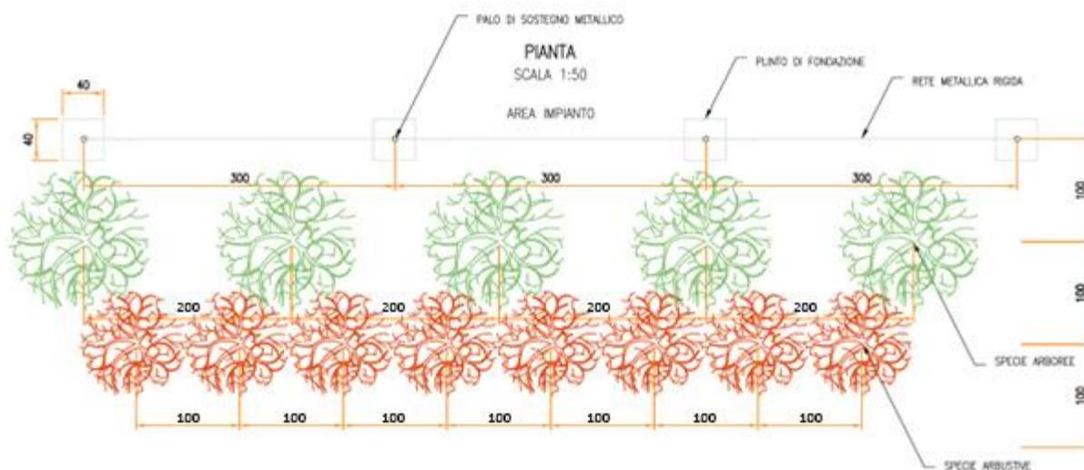
Figura 5.1: Tipologico del filare di mitigazione
