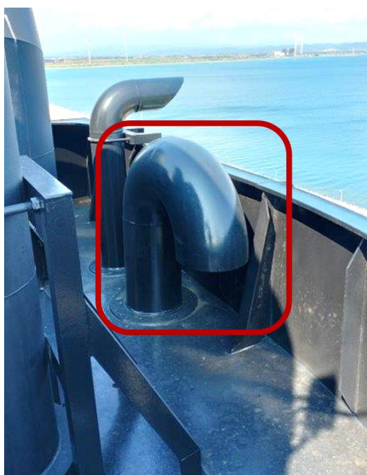
Figura 4-1: IGG vent presente sulla ciminiera
