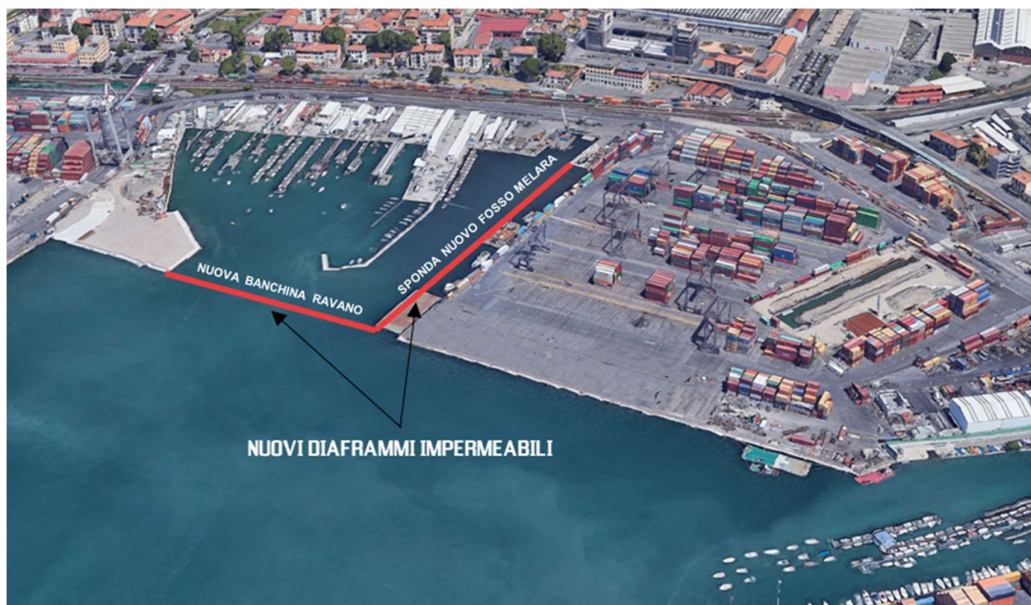
Figura 3.2 – Configurazione nuovi diaframmi impermeabili
