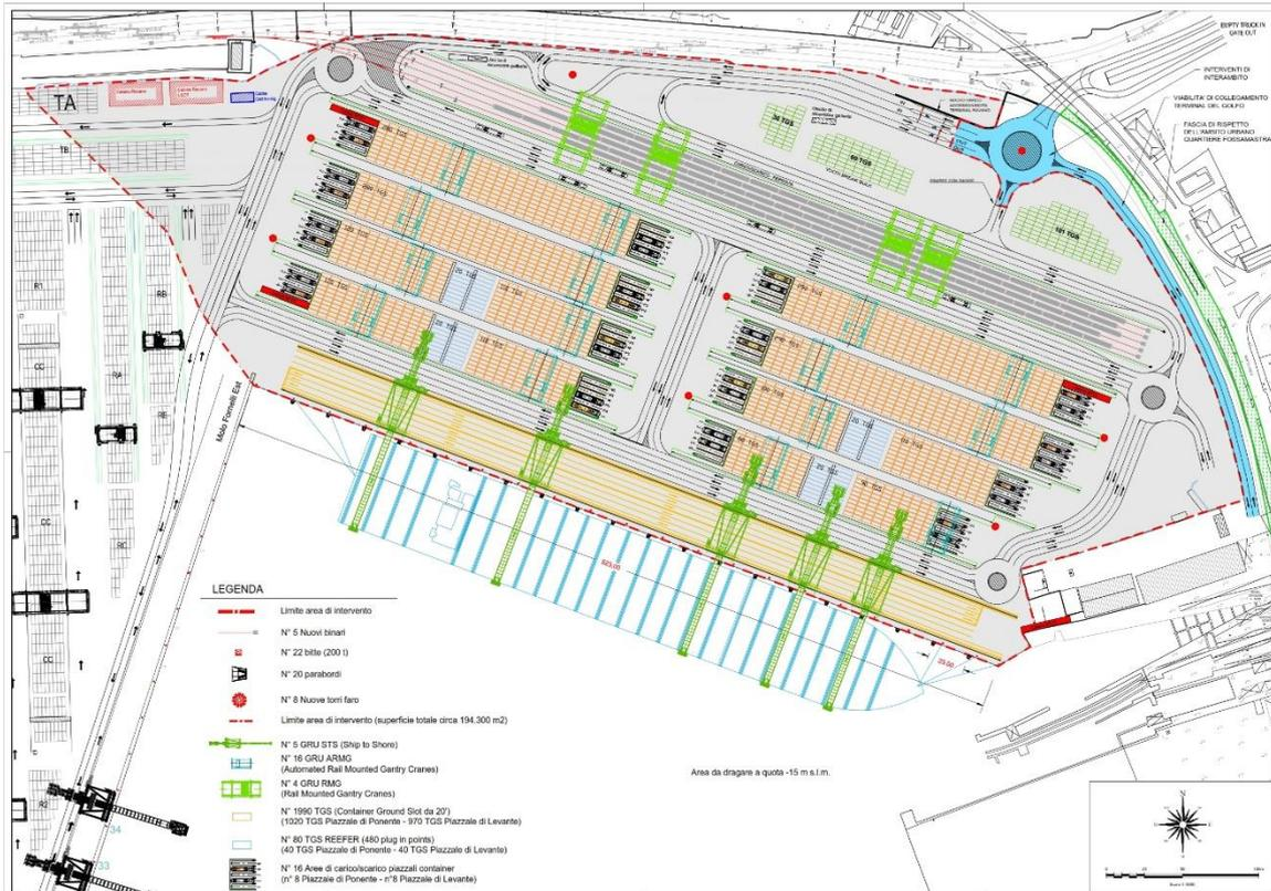
**Figura 2.1 – Nuovo terminal Ravano - Planimetria di progetto**
