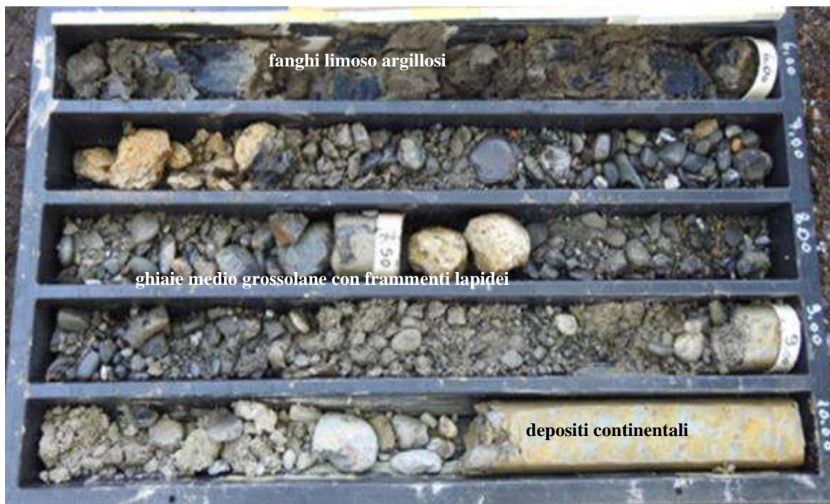
Figura 67. dettaglio dei depositi presenti tra -5 e -10 m con ghiaie medio grossolane e lapidei posti al di sotto dei depositi di ambito marino forse pertinenti ad una struttura antropica
