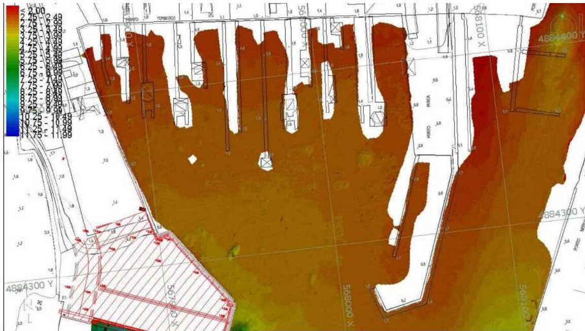
Figura 41. Immagine raster dell'elaborazione dei dati batimetrici delle Marina del Canaletto, sulla quale sono visibili alcune anomalie
