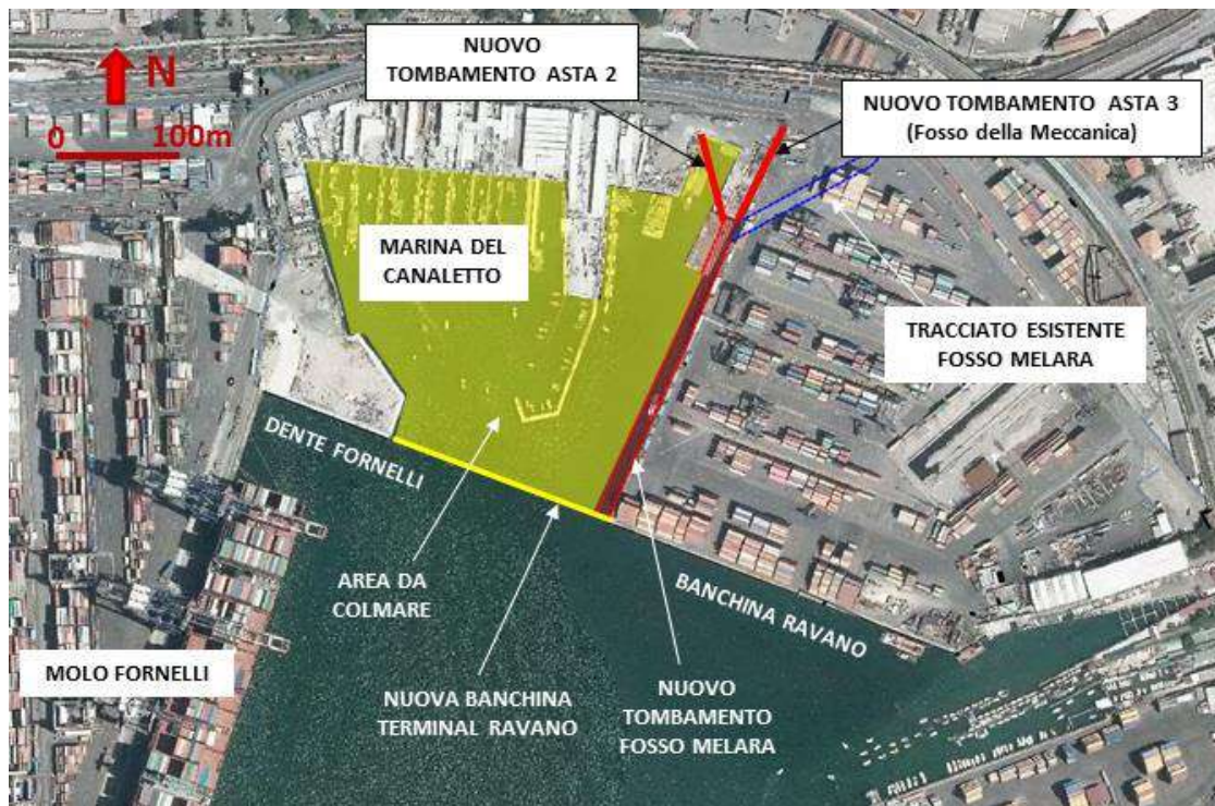
Figura 6. Ubicazione delle due aste fluviali che si andranno ad immettere nel nuovo tombamento del Fosso Melara secondo quanto previsto dalla configurazione di progetto del Nuovo Terminal Ravano
