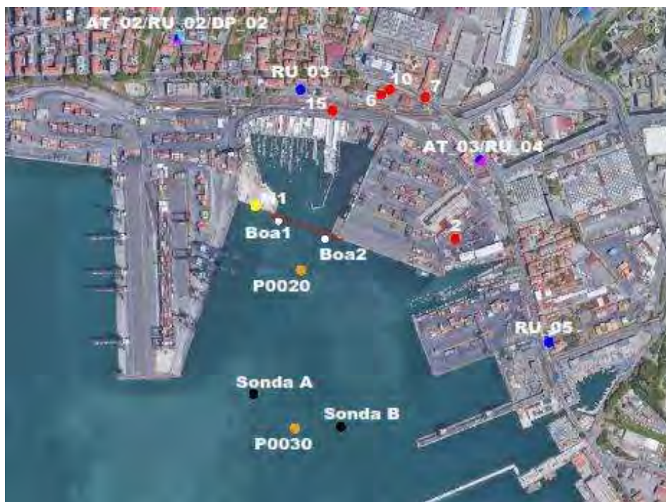
Figura 3.1 – Stazioni fisse (1 e 2) e mobili (A e B) per il monitoraggio Ambiente idrico
