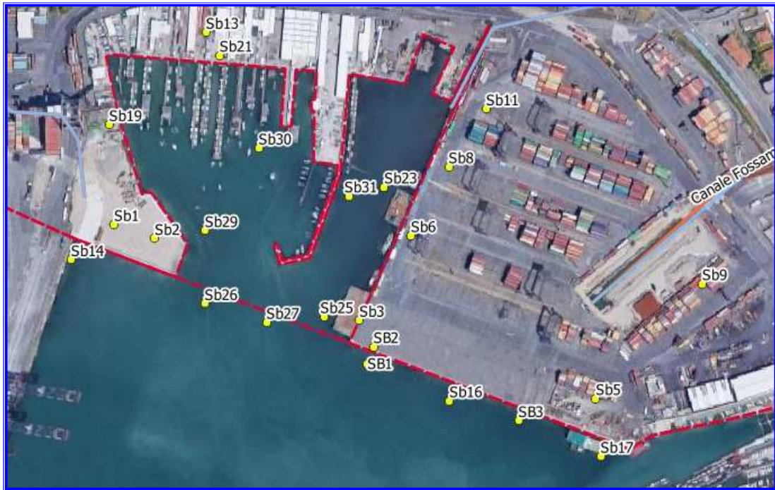
Figura 5 – Ubicazione dei sondaggi realizzati nell'ambito del PFTE
