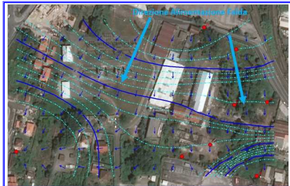
Figura 8 – Andamento delle linee di falda in corrispondenza del sito Ex Sio
