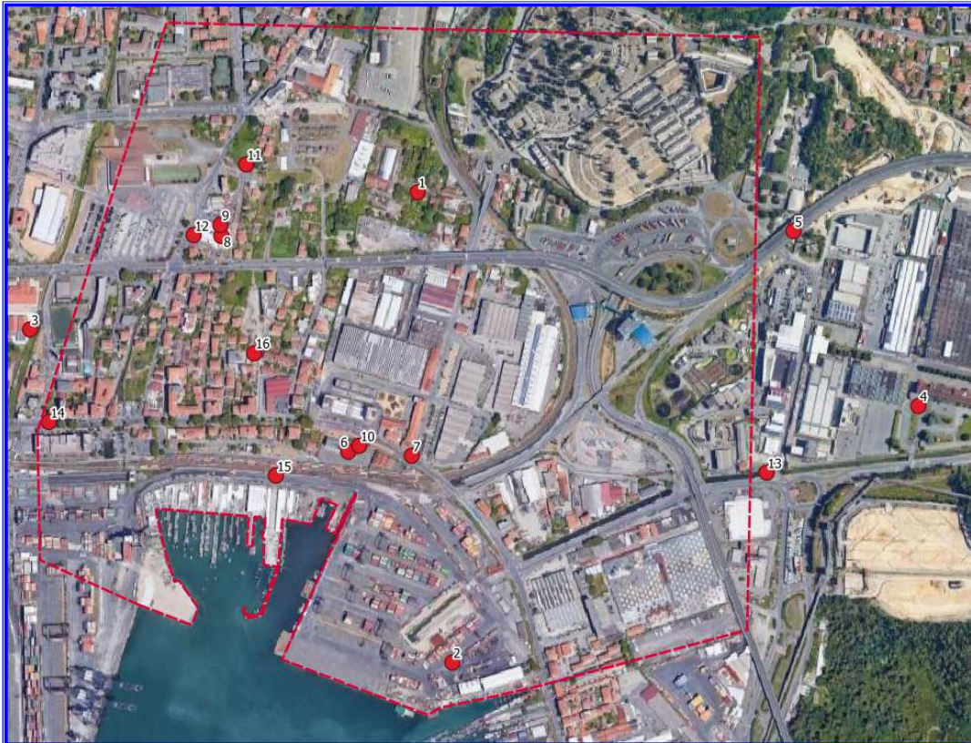
Figura 13 – Disposizione dei piezometri presi a riferimento per la ricostruzione delle isofreatiche
