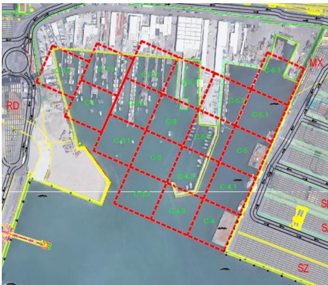
Figura 4-1 Campionamento caratterizzazione dei sedimenti marini 2021
