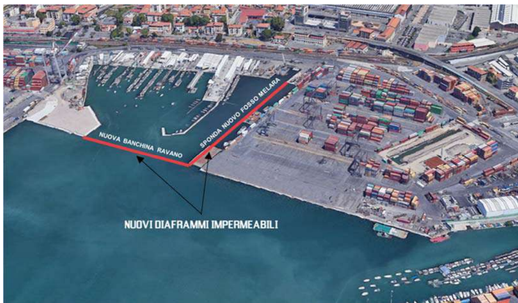
Figura 3.2 – Configurazione nuovi diaframmi impermeabili
